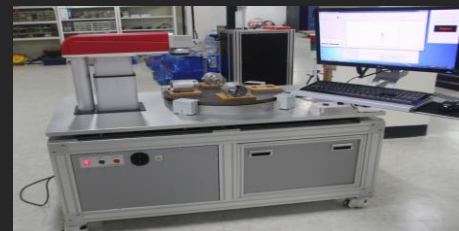
Motor Housing Marking (턴 테이블 적용)
